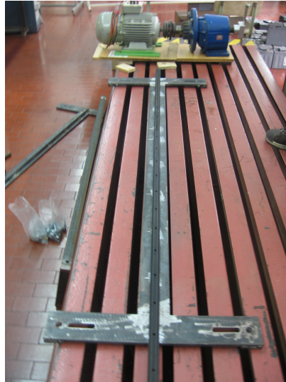
Figura 5.9 - Guia fixada na estrutura de base/topo
