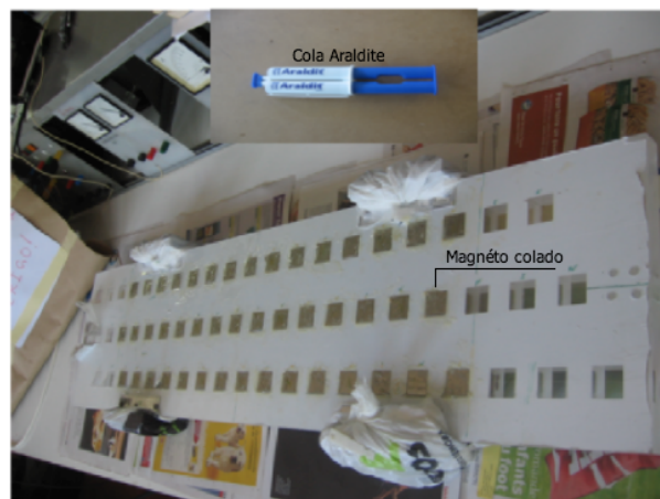
Figura 5.13 - Translador com os magnetos colados
